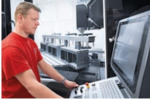
5-assig simultaan verspanen van grote componenten op de DMU 340 P.
