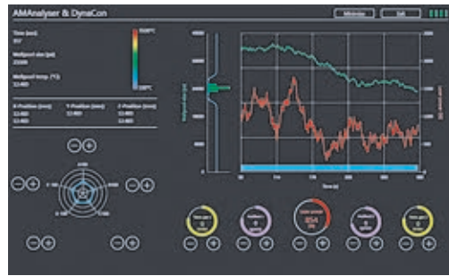
Adaptieve procescontrole automatische aanpassing van het laservermogen.
