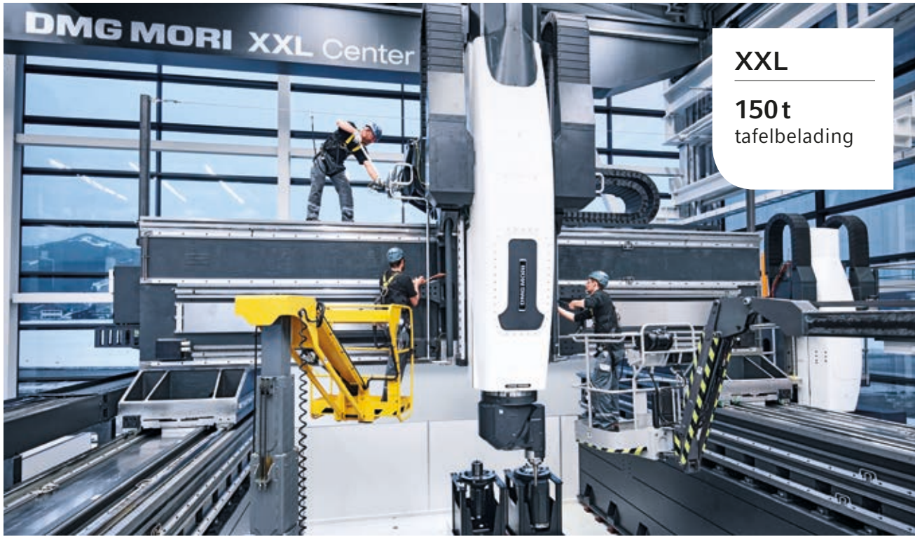
Boven: DMU 600 G linear in opbouw in het XXL-Center bij DECKEL MAHO in Pfronten, de modernste productie ter wereld van grote machines. Beneden: Gelijkblijvende hoge precisie door temperatuurstabiliteit van de machine constructie.
