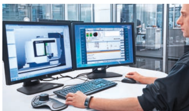
De DMG MORI Virtual Machine is een 1:1 afbeelding van de DMC 160 H duoBLOCK® inclusief de werkelijke besturing.
